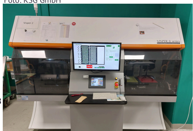
AOI-Prüfsystem der KSG-Warenausgangsprüfung „Visper“. Foto: KSG GmbH
