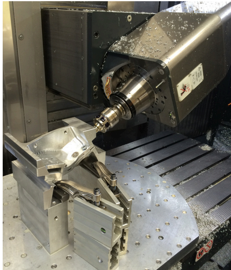
Bearbeitung eines Werkstücks durch eine Fräsmaschine in der Zerspanung. Foto: Fester & Zander Zerspanungstechnik GmbH
