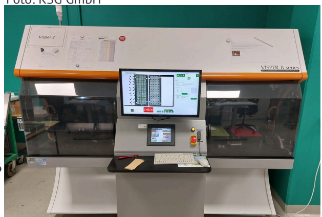
AOI-Prüfsystem der KSG-Warenausgangsprüfung „Visper“. Foto: KSG GmbH
